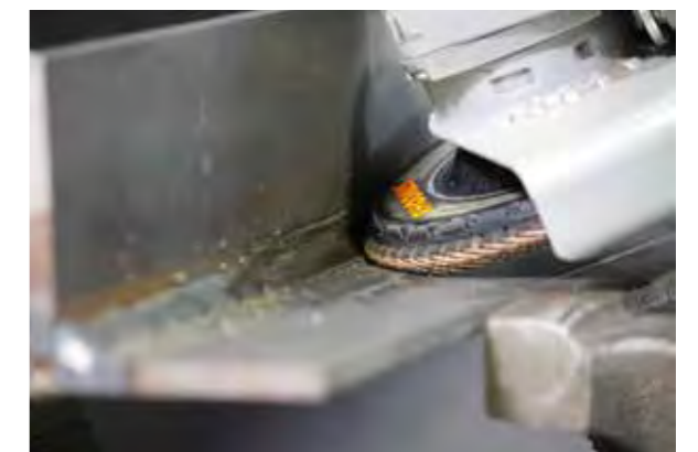
Durch Abschleifen des Lamellentragers individuell anpassbar.
