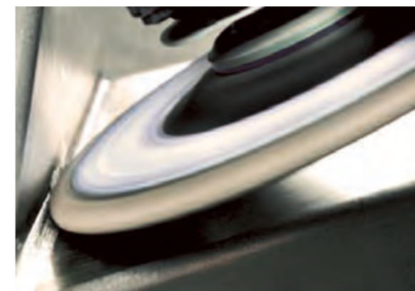
Wirtschaftlich, da vollständig aufbrauchbar bei Kehlnahtbearbeitung
