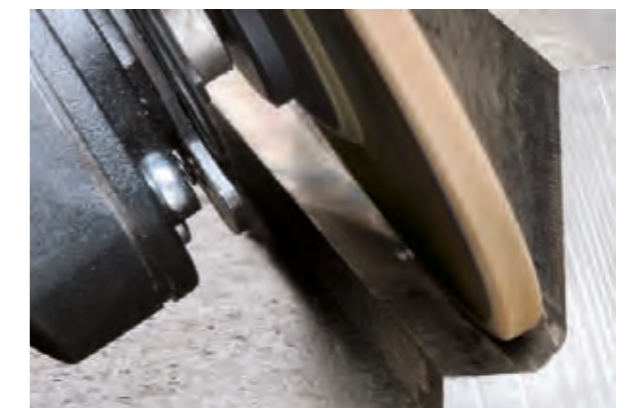
Langlebigkeit einer Schruppscheibe. Feines Schliffbild einer Fächerschleifscheibe
