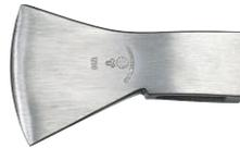
**6** Sandstrahlen der Oberfläche. Feinschleifen der Schneide. Ein balliger Schliff erhöht die Standfestigkeit. Klarlack schützt den Axtkopf vor Korrosion.
