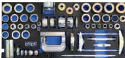
Utilisation universelle pour la réparation de roulements de roue, de systèmes de direction et d'essieu des voitures et des camionnettes.
