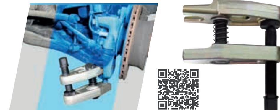
Convient aux joints à rotule du levier de colonne de direction sur les bus Mercedes Benz ou Setra, par ex. MB Travego RHD L (O 580) et Setra S 417 UL.
