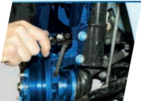
Universel, convient aux alésages de réception de capteurs ABS avec un Ø d'alésage de 18 mm.
