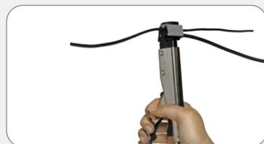
Mit Montagezange „ASPÖCK“ bis zum Anschlag pressen – fertig.
