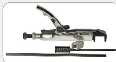
Flachkabel (2 x 1,5 mm<sup>2</sup>) in den P&R Verbinder einlegen. Montagehülse aufsetzen.
