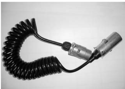
Elektrospirale, 2 Metallstecker 7-polig 24 V, DIN/ISO 1185, Leitungsquerschnitt: 6 x 1,0 + 1 x 1,5 mm 2 , Länge: 4,5 m Câble électrique spirale
